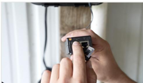
2) Connectez l'autre extrémité du câble Ethernet au port d'alimentation et de données du bloc d'alimentation 55v SenseHub® fourni dans la boîte avec le contrôleur. Connectez ensuite un autre câble Ethernet entre le port « *Data Only* » (données uniquement) de ce bloc d'alimentation et le routeur Internet ou le commutateur réseau. Une fois la connexion Internet établie, le voyant du contrôleur passe du rouge au vert.
