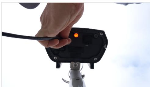
1) À l'aide d'un câble Ethernet, connectez une extrémité du câble au port PD du contrôleur SenseHub®.
