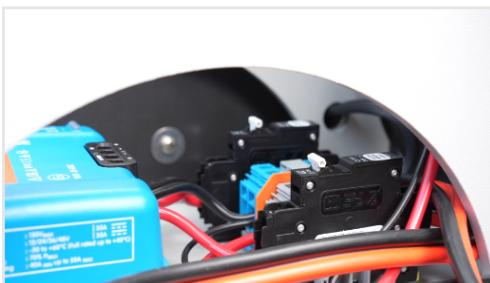
2) Assurez-vous que les deux interrupteurs du disjoncteur sont en position « *on* » (marche) sous le convertisseur.
